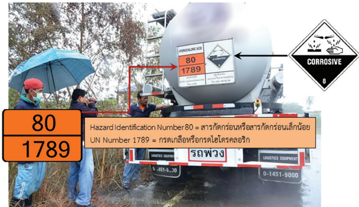
รูปที่ 1 ชุดหมายเลขของ UN สำหรับแสดงประเภทและชนิดของสารเคมี ที่มา: ไทยรัฐออนไลน์ 9 เม.ย. 2555 ( https://www.thairath.co.th/content/251894 )
